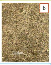
Morfologia depunerilor de crom obtinute din electrolit oxalat-sulfat pe bază de crom trivalent (i<sub>k</sub> = 4,0 kA/m², t = 40°C, pH =0,95, durata 3 ore): a – electrolit initial (conventional); b – electrolit modificat, cu utilizarea DIC
